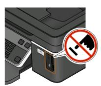
**Aviso—Dano Potencial:** não toque nos cabos, em qualquer adaptador de rede, em qualquer conector, no dispositivo de memória ou nas áreas mostradas enquanto a impressora estiver imprimindo, lendo ou gravando do dispositivo de memória. Dados podem ser perdidos.
