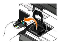
**Aviso—Dano Potencial:** Não toque no filtro de tinta do cabeçote de impressão nem nos orifícios do cabeçote de impressão.
