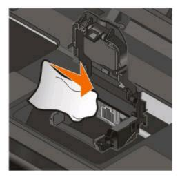
**Aviso—Dano Potencial:** Não toque no filtro de tinta do cabeçote de impressão nem nos orifícios do cabeçote de impressão.
