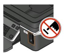
**Aviso—Dano Potencial:** não toque no cabo USB, em qualquer adaptador de rede, em qualquer conector, no dispositivo de memória ou nas áreas mostradas enquanto a impressora estiver imprimindo, lendo ou gravando do dispositivo de memória. Dados podem ser perdidos.
